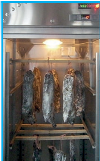
Armoires autonomes pour le séchage de salaisons
